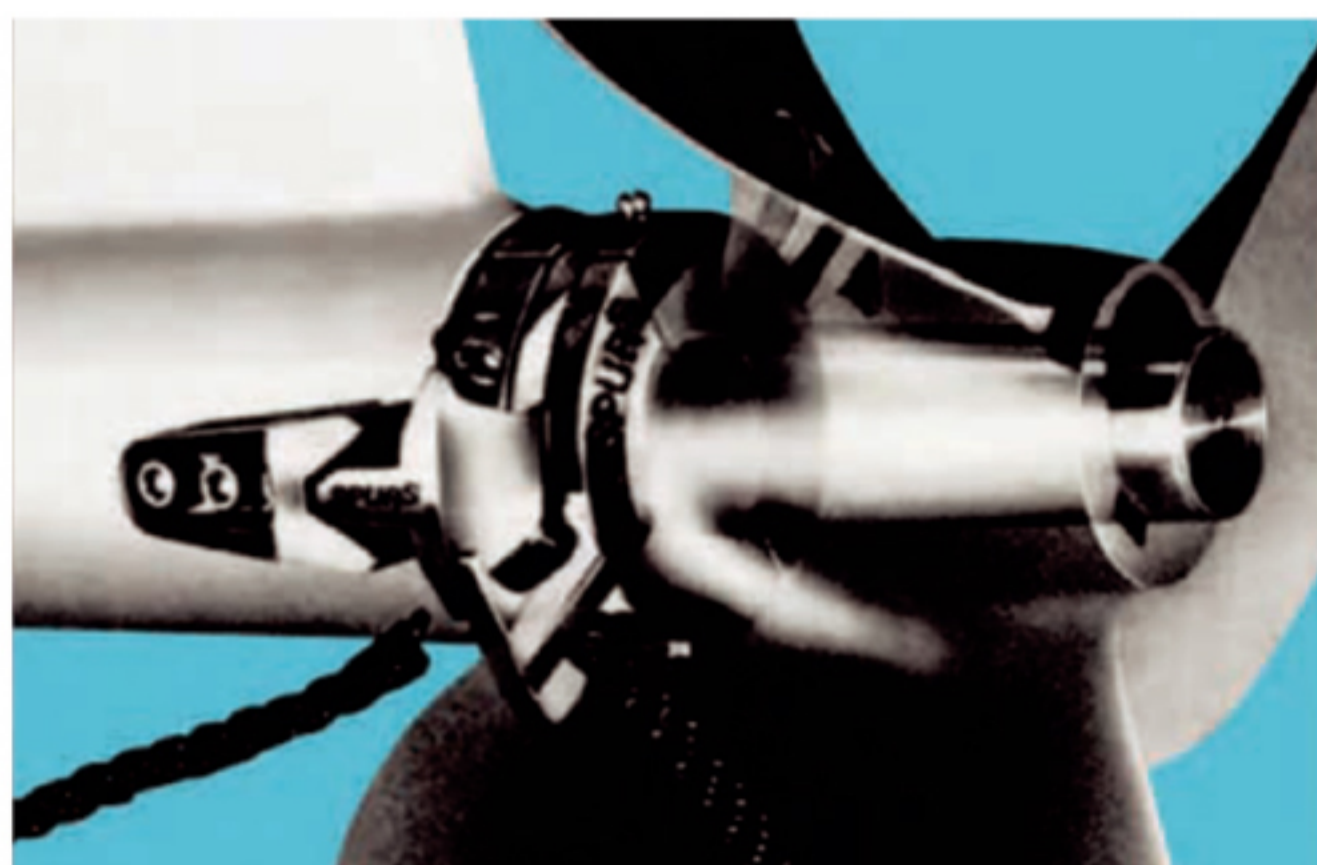
プロペラの1回転ごとに切断します。(前後進とも) スピードや効率は落ちません。
